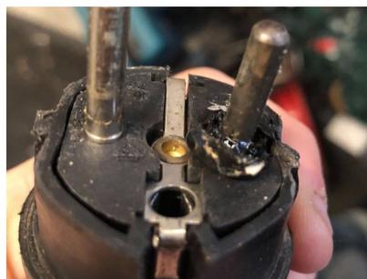
Anschluss der Zuleitung darf nur durch eine Elektrofachkraft unter Beachtung der anerkannten Regeln der Technik sowie des Spannungsfalls erfolgen. Die Zuleitung (Länge und Querschnitt) ist nach Herstellervorgaben auszuwählen sowie fest anzuschließen. Es darf kein Schukostecker verwendet werden! Die TAB (Technische Anschlussbedingungen) des für Sie zuständigen Verteilnetzbetreibers ist zu beachten!
